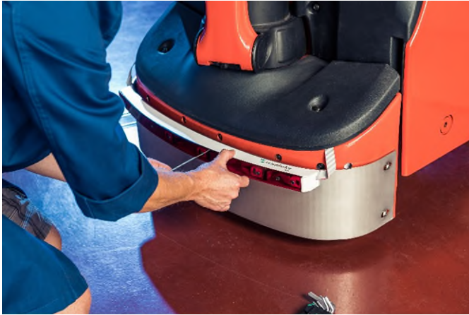
Abb. 3 Spezielle optische Sensoren des Fraunhofer-Anwendungszentrums AZOM sollen Transportunfälle mit Flurförderfahrzeugen senken.
